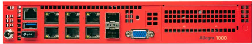
Allegros Network Multimeter bietet diverse LAN-Anschlüsse. WLAN-Konnektivität stellt ein USB-Adapter her, der sich im Lieferumfang befindet (Abb. 1).
